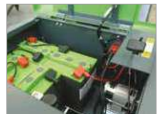
ALOJAMIENTO DE BATERÍAS (1280 E)
