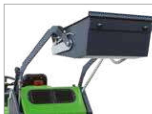
SISTEMA HIDRÁULICO DE DESCARGA DEL DEPÓSITO
